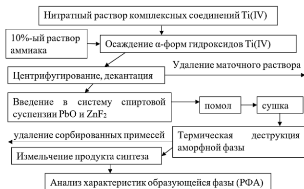
Рис. 1. Принципиальная технологическая схема формирования УДП фаз системы \text{PbTi}_{1-x}\text{Zn}_x\text{O}_{3-2x}\text{F}_{2x} ( 0 < x < 0,2 )
