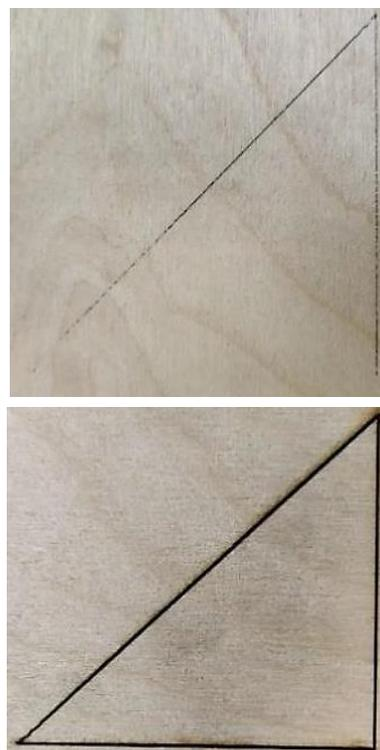
Рис. 8. Результаты резки на установке с CO<sub>2</sub> лазером RECI. Слева – без поворота плоскости поляризации, справа – при использовании динамического поворота плоскости поляризации
