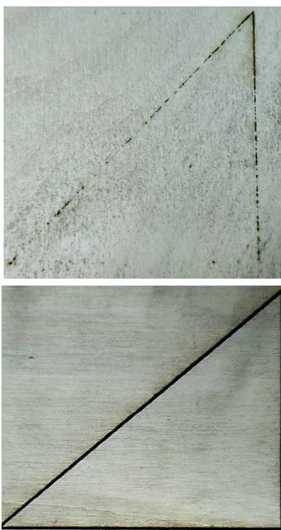
Рис. 7. Результаты резки на установке Trotec. Слева – без поворота плоскости поляризации, справа – при использовании динамического поворота плоскости поляризации
