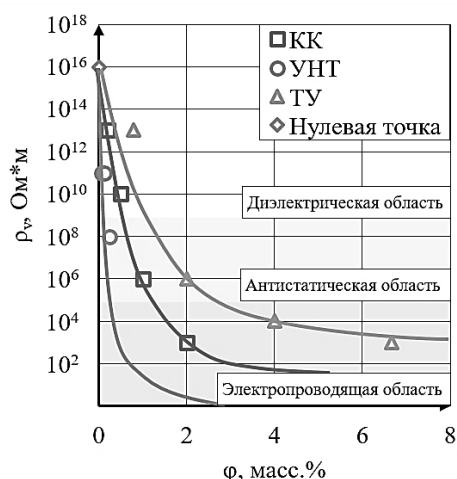
Рис. 3. Зависимость удельного объемного электрического сопротивления электропроводных ПКМ ПФС СВ-40 от содержания УН
