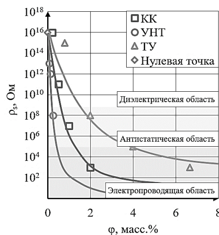
Рис. 4. Зависимость удельного поверхностного электрического сопротивления электропроводных ПКМ ПФС СВ40 от содержания УН
