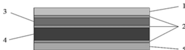
Рис. 4. Конструкция оболочки для воздухоплавательной техники: 1, 5 – высокопрочная пленка из ПФС; 2 – адгезив; 3 – газодержащая пленка из ПИ; 4 – арамидная ткань
