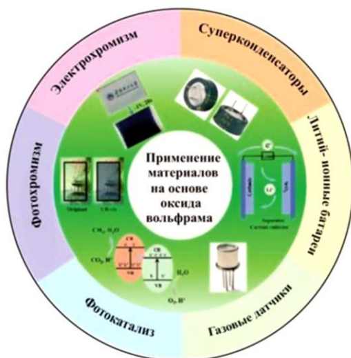
Рис. 1. Технологические приложения пленок \text{WO}_3
