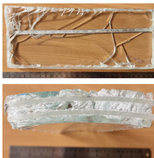
Рис. 5. Фрагмент триплекса прямоугольной формы из трех прозрачных бесцветных стекол, внутри под первым стеклом металлическая полоса шириной 16 мм, диаметр изгиба около 1200 мм: а) – вид 1; б) - вид 2
