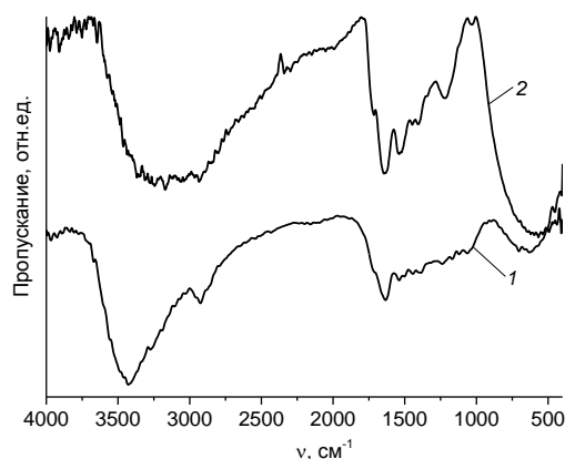
Рис. 3. ИК-спектры волокон шерсти до (1) и после (2) гидротермальной пропитки полигидроксокомплексами титана
