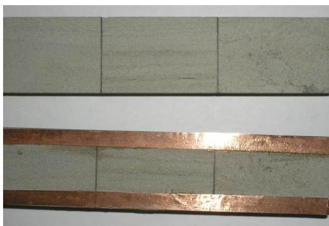
Рис. 4. Фотография модели идеальной трещины
