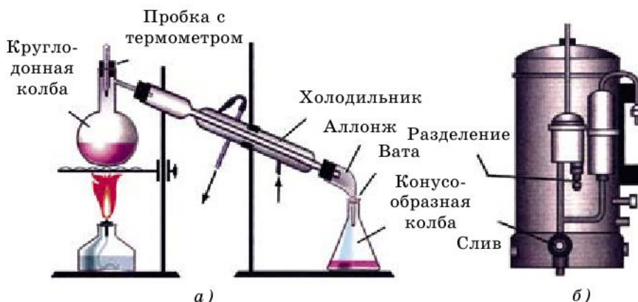
Рис. 1. Способы очистки воды а) перегонка, б) установка по получению дистиллированной воды
