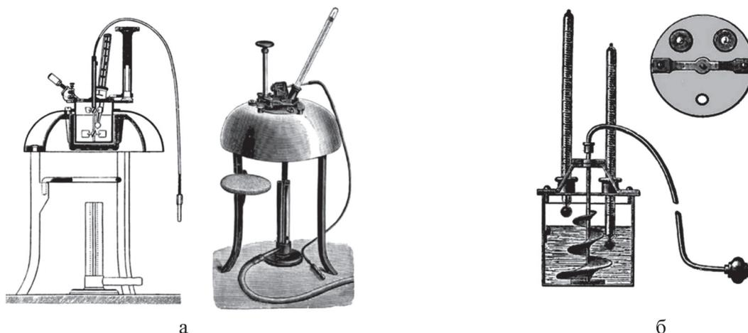
Рис. 10. Прибор Пенски-Мартенса (а) [27, 46, 76], полузакрытый аппарат Пенского (б) [27, 43, 46, 76, 77]
