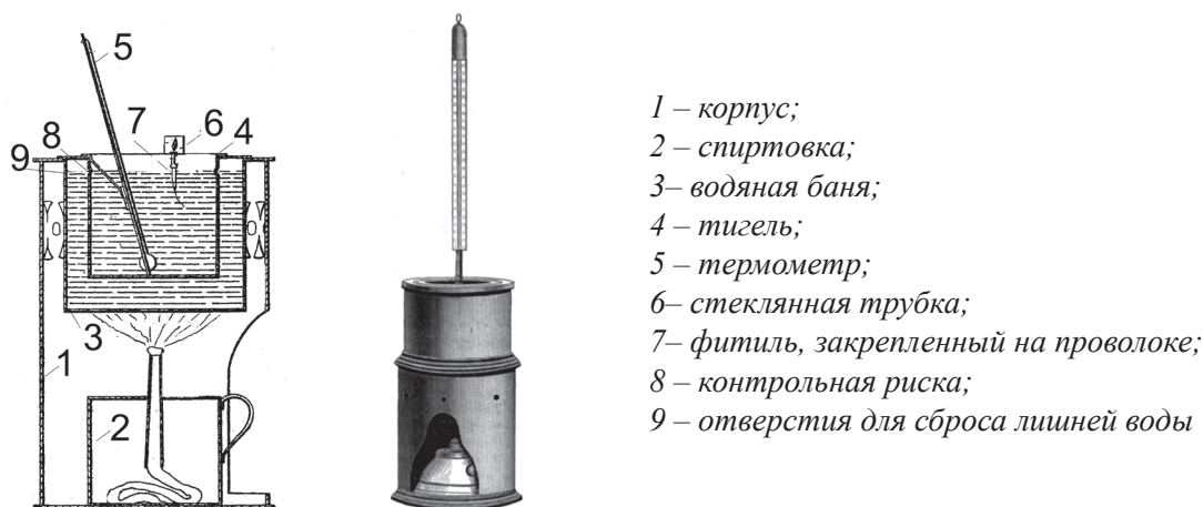
Рис. 2. Прибор Джона Тальябу для определения температуры вспышки [19, 20]
