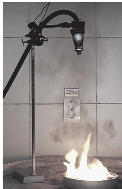
Рис. 10. Общий вид проведения испытания на огнетушащую эффективность
