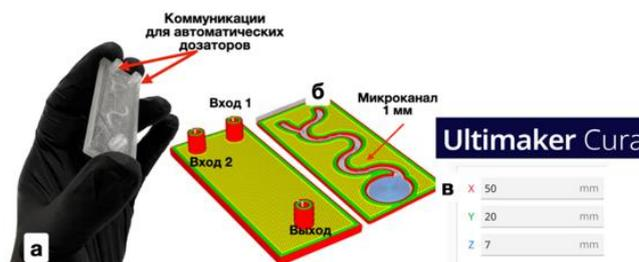
Рис. 1. Изготовленный прототип устройства микрофлюидики (а) на основе наполненных 1 вес.% фотохромов ПЭТГ филаментов (б), конфигурации 50×20×7 мм (в)
