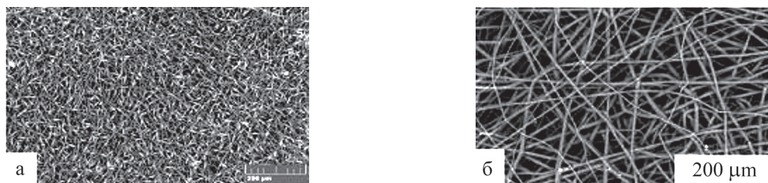
Рис. 5. Микрофотографии волокнистых материалов ПГБ (а) и ПГБ+3 % Fe(III)СfTfP, выполненные с помощью СЭМ
