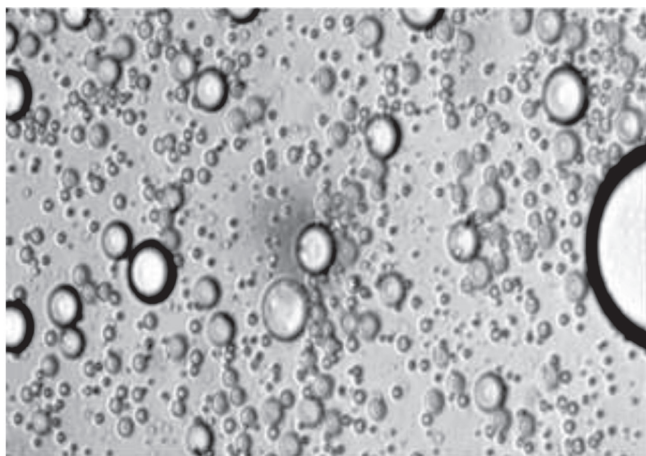
Рис. 4. Эмульсия М/В при 6000 об/мин (ПАВ ЭПЛ-1) под 400 – кратным увеличением микроскопа
